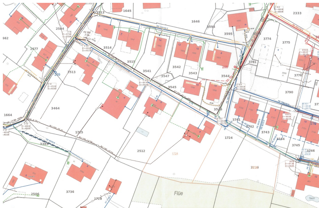
Übersichtsplan der bestehenden Werkleitungen am Tannenweg
