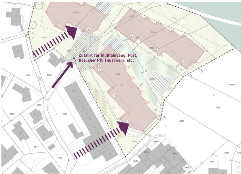
Abb. 20: Schematische Darstellung der möglichen Zufahrten zur neuen Tiefgarage
