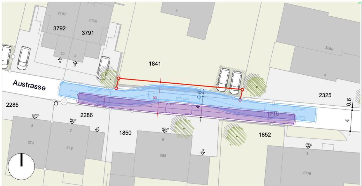
Abb. 30: Var. 2 Zusätzliches Angebot Begegnungsfall PW/LW, Schleppkurvenprüfung Platzbedarf
