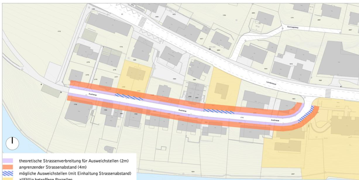
Abb. 13: Überprüfung Strassenabstand mit einer allfälligen Verbreiterung der Strasse für eine Ausweichstelle PW / LW
