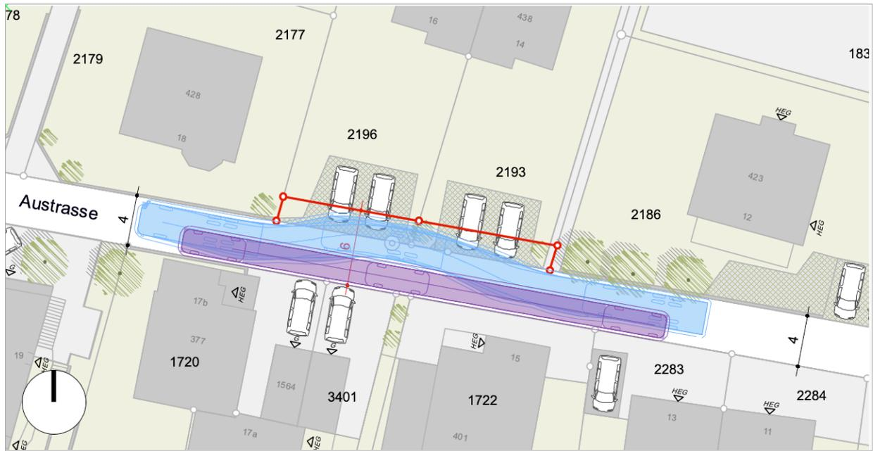
Abb. 29: Var. 1 Zusätzliches Angebot Begegnungsfall PW/LW, Schleppkurvenprüfung Platzbedarf
