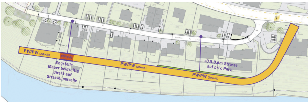
Abb. 6: Schema heutige Dimensionierung für Begegnungsfälle bei tiefer Geschwindigkeit
