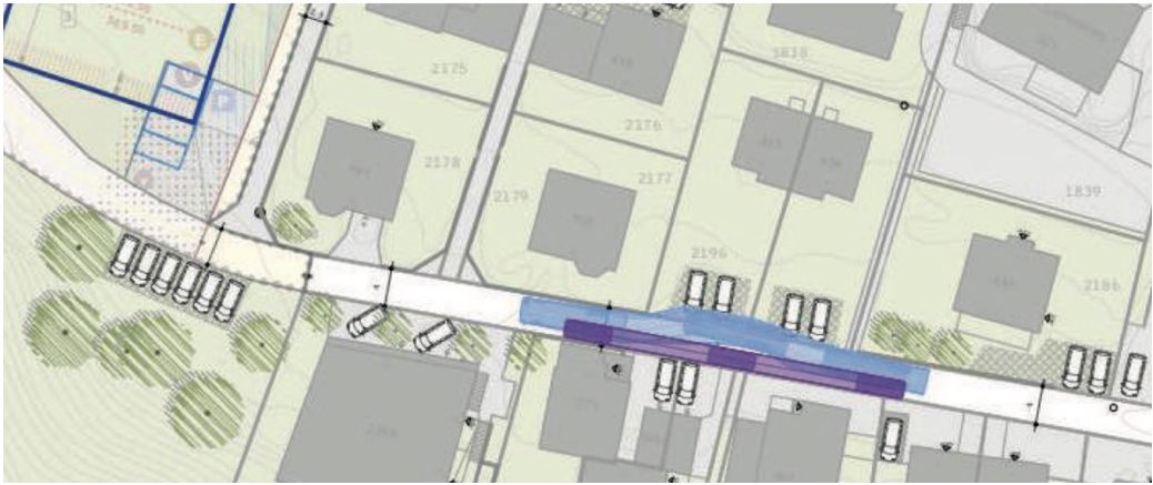
Abb. 29: Var. 2 Zusätzliches Angebot Begegnungsfall PW/LW, Schleppkurvenprüfung Platzbedarf
