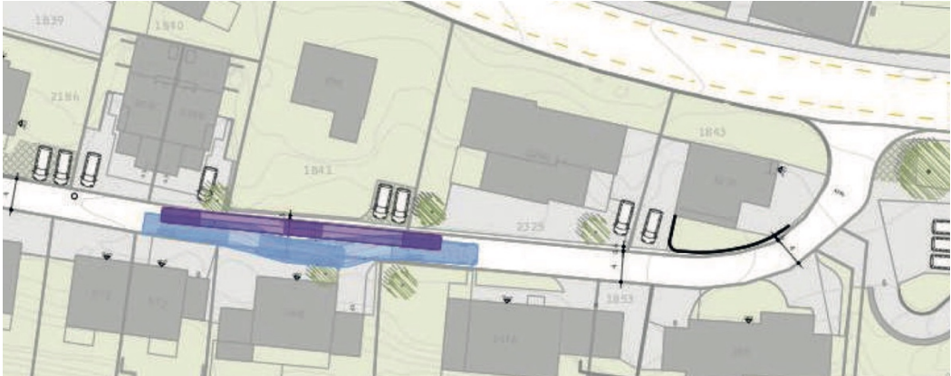
Abb. 30: Var. 3 Zusätzliches Angebot Begegnungsfall PW/LW, Schleppkurvenprüfung Platzbedarf
