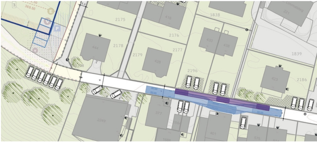
Abb. 28: Var. 1 Zusätzliches Angebot Begegnungsfall PW/LW, Schleppkurvenprüfung Platzbedarf
