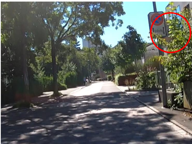
Abbildung 31 Gefahrensignal «Kinder» nicht sichtbar hinter dem Parkverbots-Schild und der Bepflanzung
