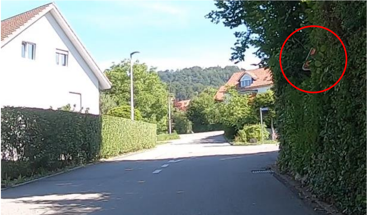
Abbildung 25 Gefahrensignal «Kinder» erst sehr spät erkenn- und lesbar in der Hecke (Kreis)
